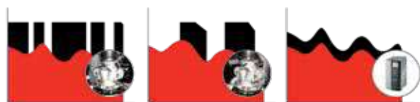
Belastnings-/ aflastningssystem System med sugemodulation Strømbesparelse med VFD-system ■ Faktisk luftforbrug ■ Kompressorlufttilførsel
